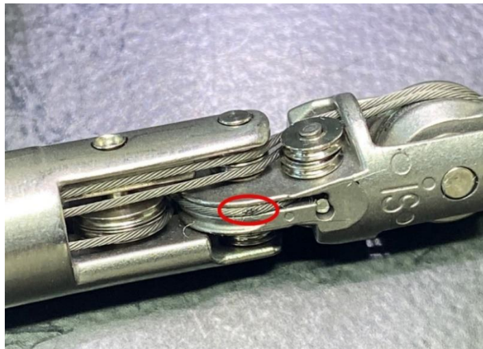
Figura G: Cablu de înclinare zdrențuit
