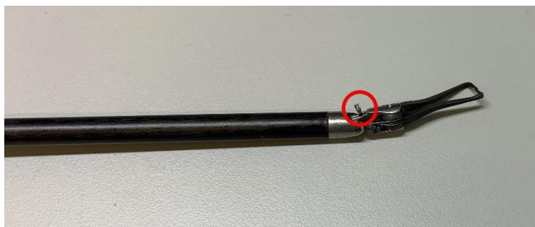
Figura F: Cablu de înclinare rupt
