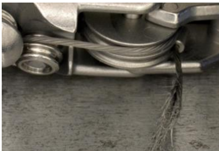
Figura C: mărire de 20x a imaginii unui cablu de prehensor rupt pe un instrument da Vinci Xi.
