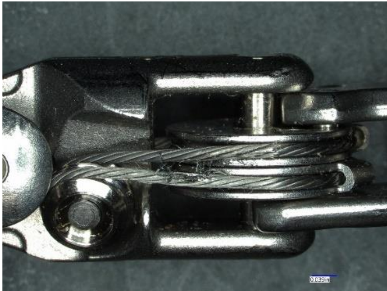
Figura D: Mărirea de 20x a imaginii unui cablu de prehensor zdrențuit al unui instrument da Vinci Xi
